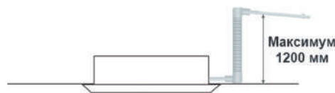
Мощность напора дренажного насоса — 1,2 м
