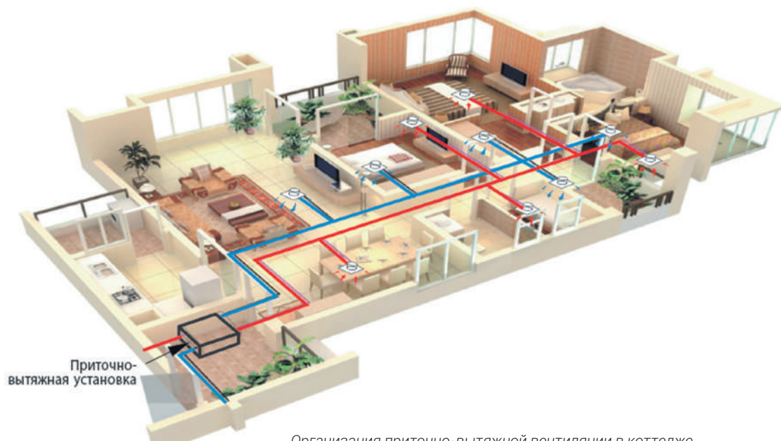
Организация приточно-вытяжной вентиляции в коттедже
