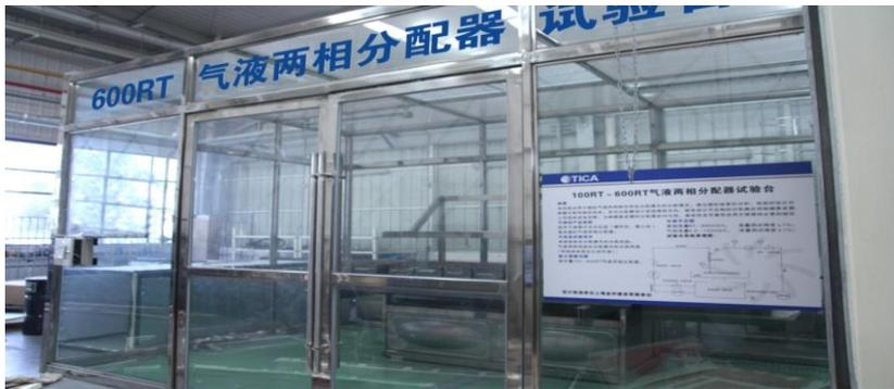
Стенд для испытаний чиллеров с затопленным испарителем мощностью до 600 RT (2110 кВт)
