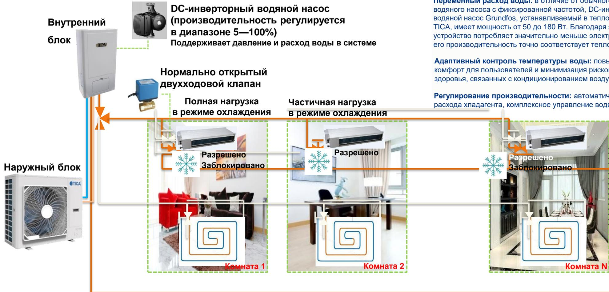
**Переменный расход воды:** в отличие от обычного 500-ваттного водяного насоса с фиксированной частотой, DC-инверторный водяной насос Grundfos, устанавливаемый в тепловых насосах TICA, имеет мощность от 50 до 180 Вт. Благодаря этому устройство потребляет значительно меньше электроэнергии, а его производительность точно соответствует тепловой нагрузке.
